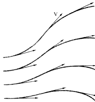
FIGURA 3.1 - LINHAS DE CORRENTE-TANGENTE AO VETOR VELOCIDADE LOCAL, fonte: Ref[1]
