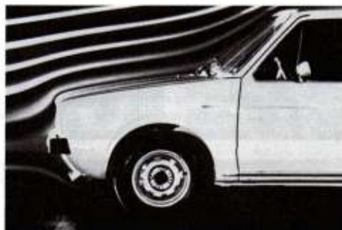
FIGURA 4.13 - LINHAS DE CORRENTE NO VW GOLF I NUM TUNEL DE VENTO, fonte: Ref[4]
